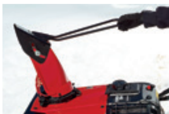
Manuell kontroll av utkastet på HS 750 EMA
